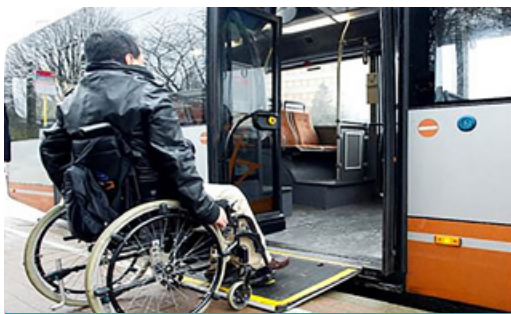
> Rampe d'accès sur le véhicule
