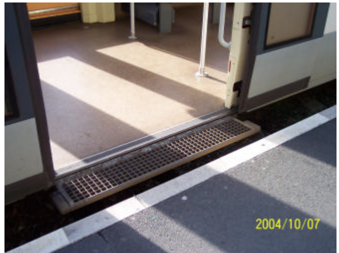
De toegang tot de tram-trein wordt voor mindervaliden vergemakkelijkt door een lage vloer op de hoogte van het perron
